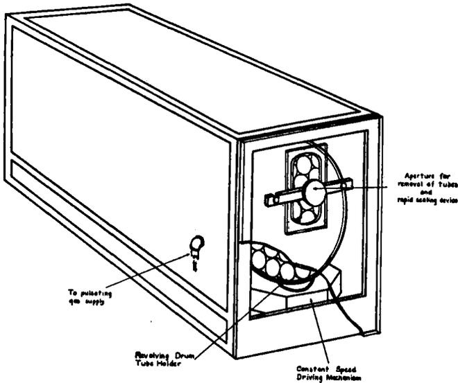
FIG. 2. GAS-TIGHT CHAMBER FOR ROLLER TUBE CULTURES
