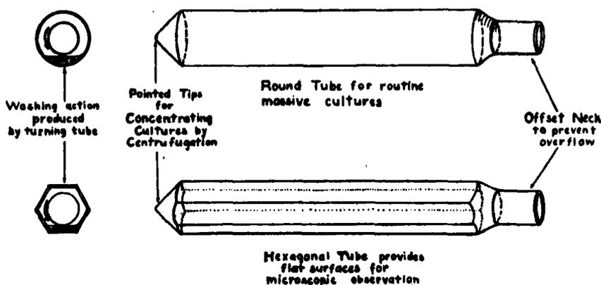
FIG. 1. ROLLER CULTURE TUBE FOR HORIZONTAL OPERATION
